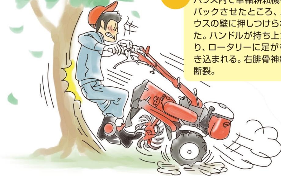
**事例** ハウス内で車軸耕耘機をバックさせたところ、ハウスの壁に押しつけられた。ハンドルが持ち上がり、ロータリーに足が巻き込まれる。右腓骨神経断裂。
